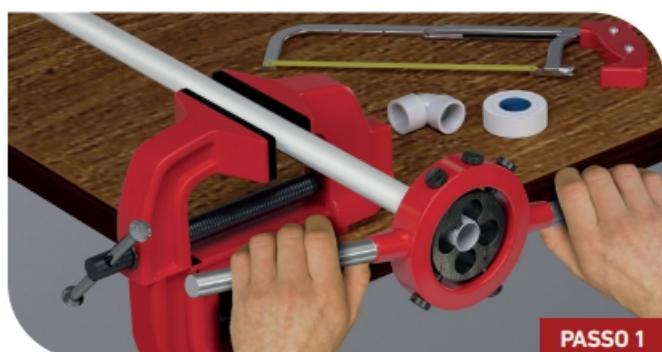
Cortar o Tubo no esquadro e executar a rosca com uma tarraxa, até que a extremidade do Tubo fique alinhada com o final da tarraxa.
