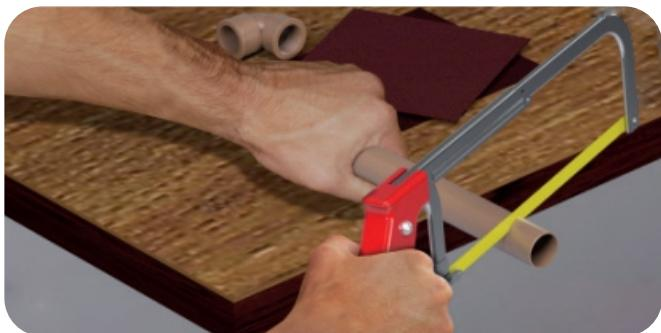
Corte o tubo no esquadro (ângulo reto) e faça o chanfro nas extremidades usando uma rasqueta ou chanfrador. Lixe as superfícies a serem soldadas (a ponta do tubo e a bolsa da conexão) para garantir uma boa aderência da solda. Limpe as superfícies lixadas utilizando a Solução Preparadora, que remove impurezas e aumenta a aderência.
